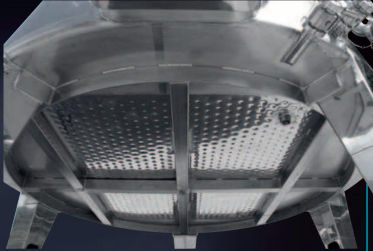
Fond plat incliné de 3% en avant, thermoconditionné avec Termostar
