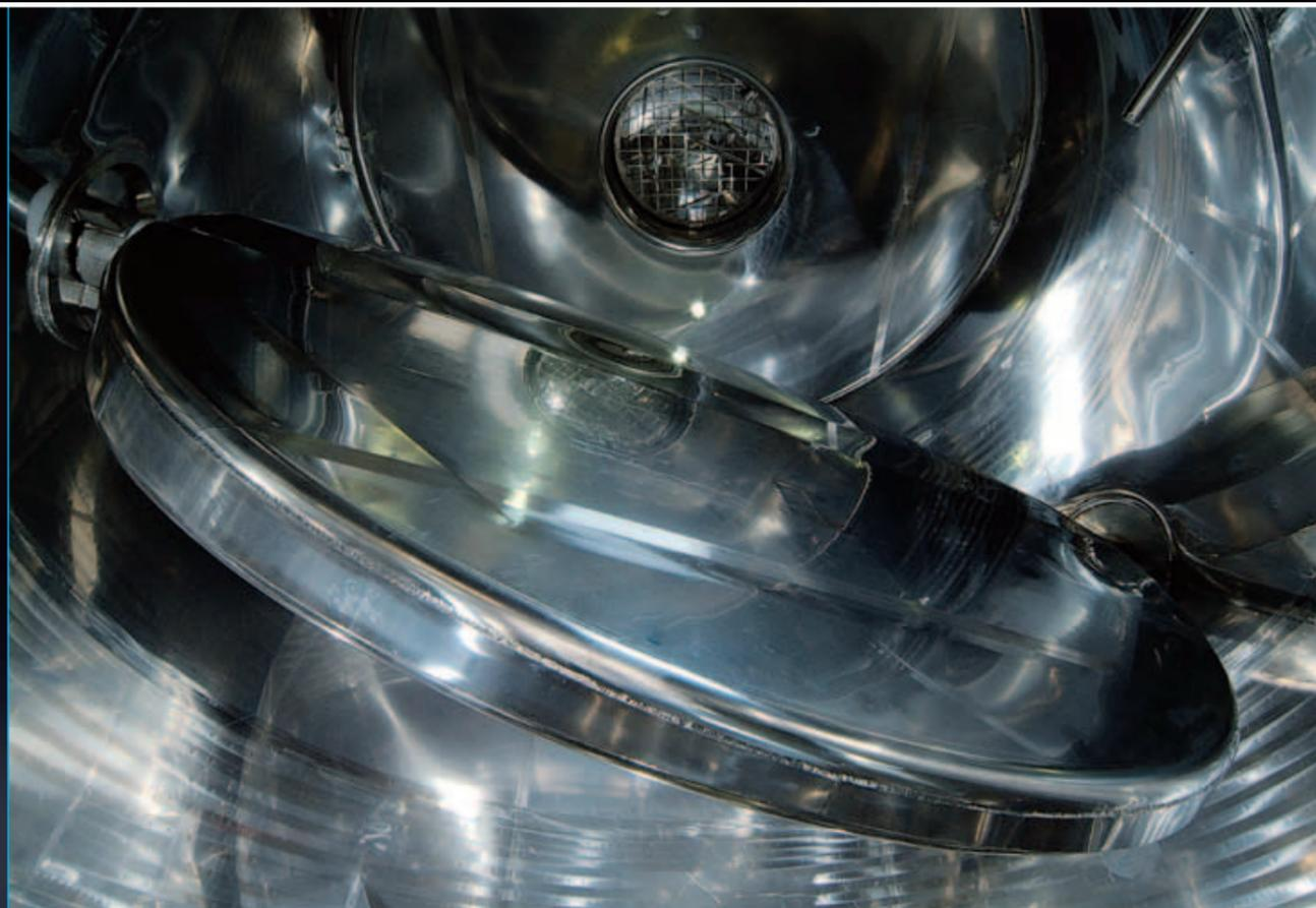
Pale tournante, brevetée par Albrigi, à disque entier thermoconditionnée sur les deux côtés
