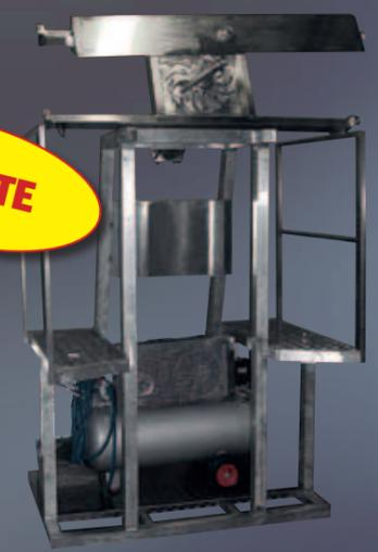
Mécanisme sur base mobile pour le pigeage avec pale autorotative sur réservoir « Variotank »
