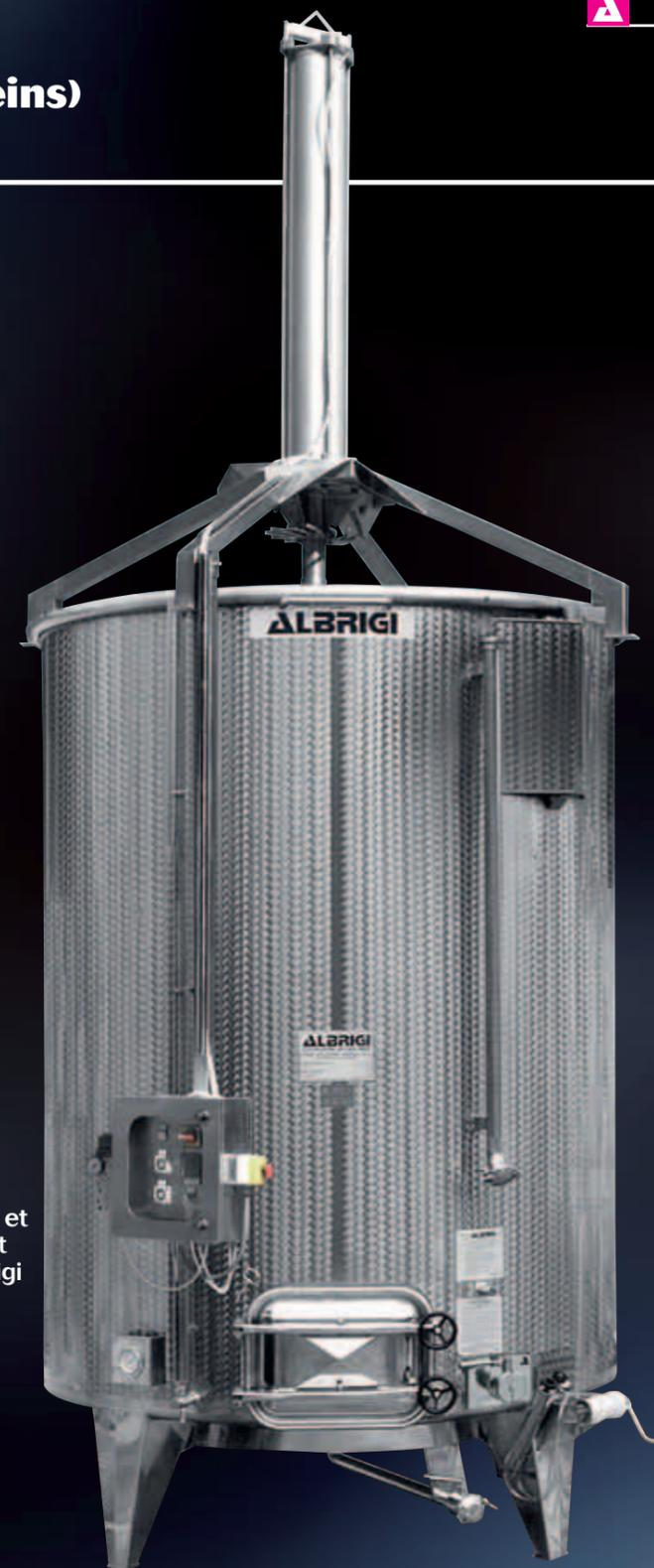
Variofolltank sur réservoir Variotank de 100 hl avec tableau de commande pour régler les phases de pigeage
