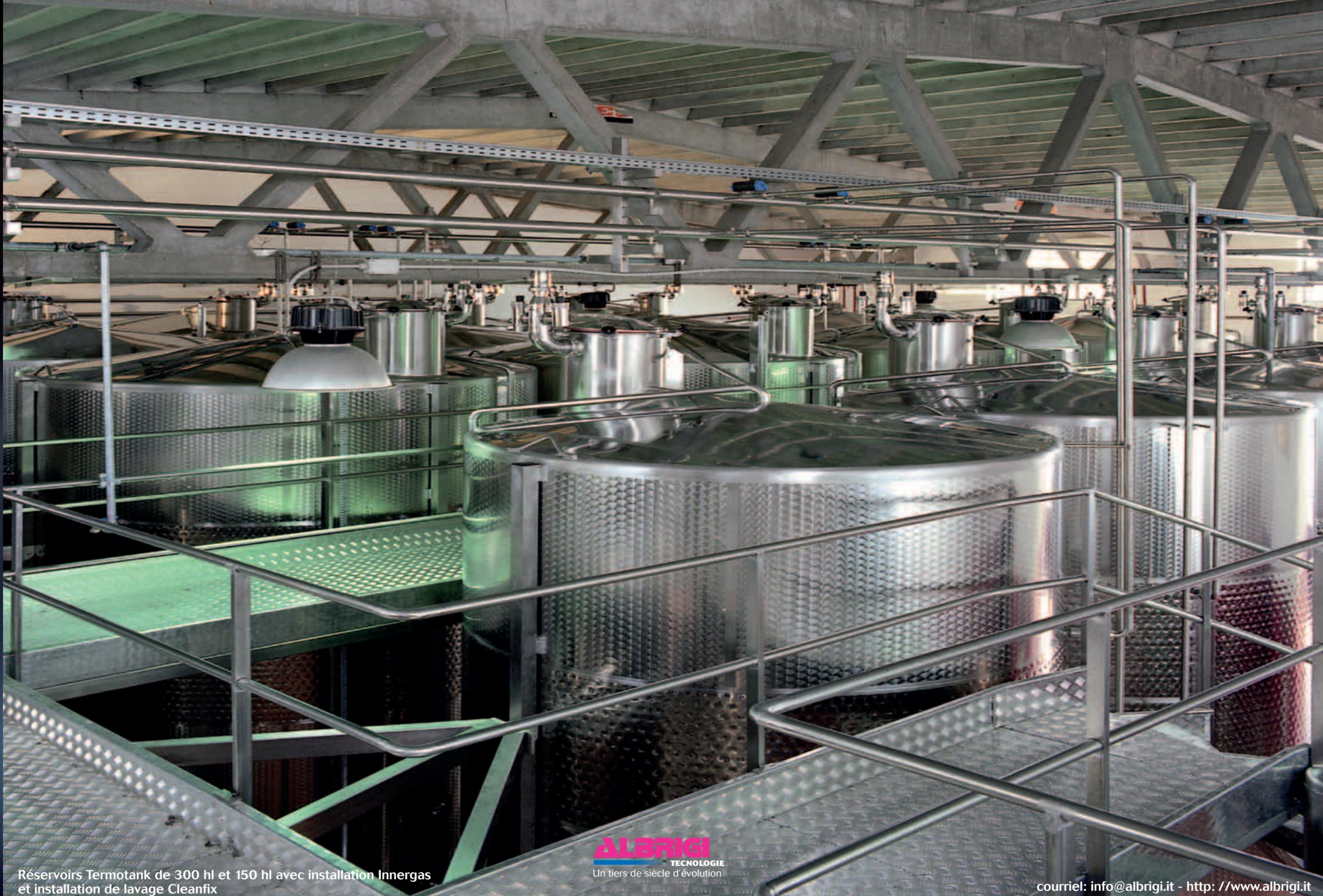
Réservoirs Termotank de 300 hl et 150 hl avec installation Innergas et installation de lavage Cleanfix
