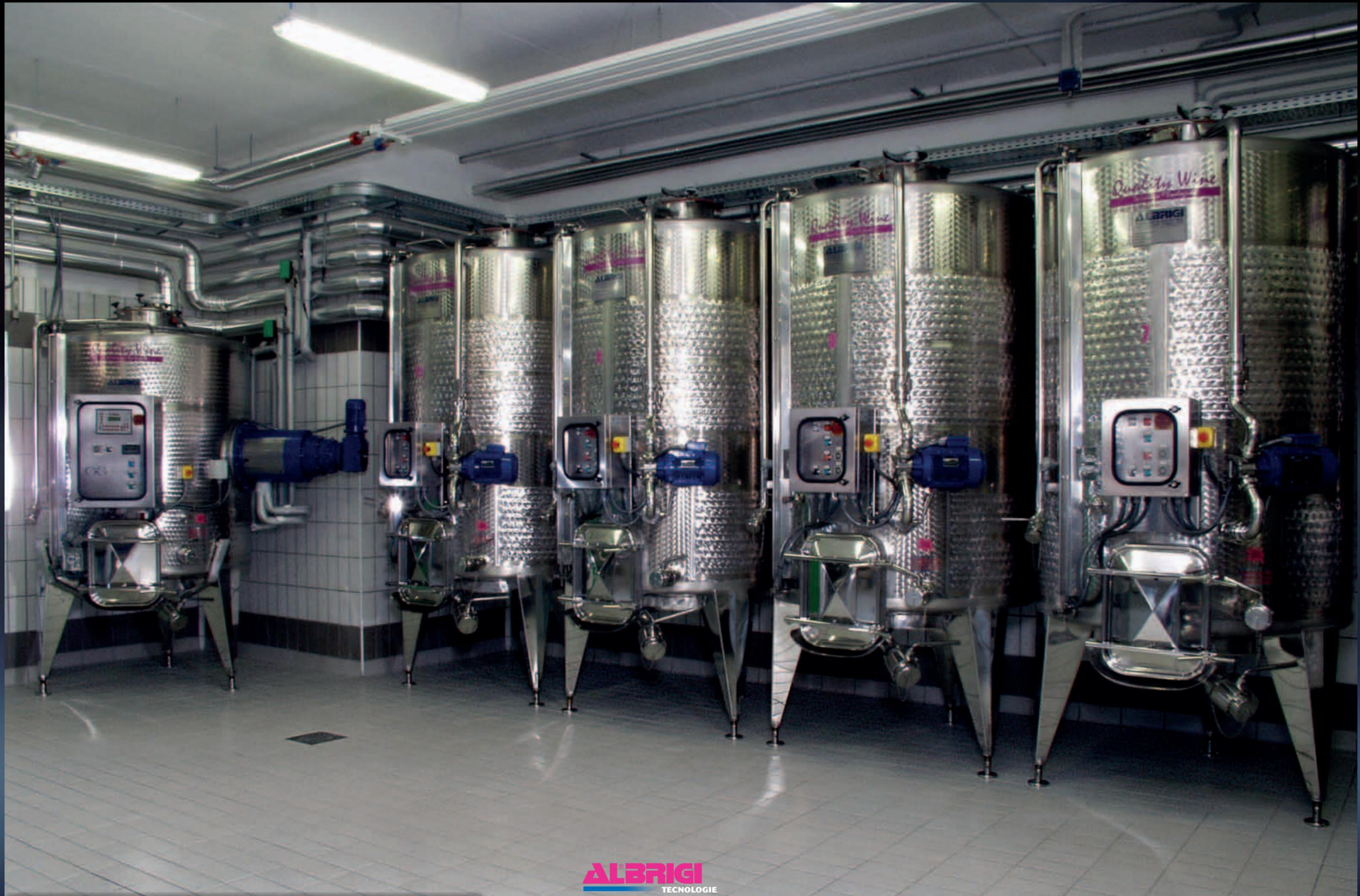
Réservoirs Volvotank de 20 hl et fermentateurs Specialtank thermoconditionnés avec Termostar et pompe de remontage de 25 hl
