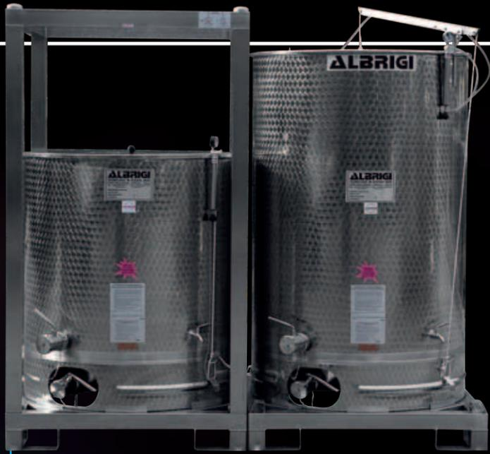
Réservoir Enopalet de 1000 l et 1500 l avec couvercle pneumatique, contenance variable
