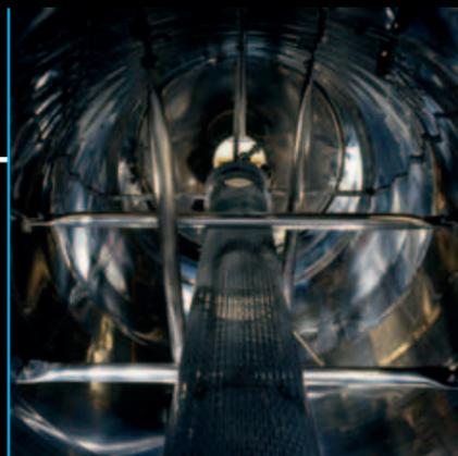
Mécanisme Palitank avec grille de drainage au milieu
