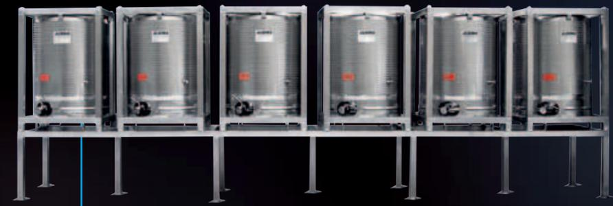
Batterie de réservoirs palettisables de 10 hl rehaussés pour la revente de vins en vrac avec installation d'azote
