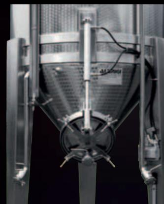
Réservoir Gravitank avec porte fermée et verrouillée
