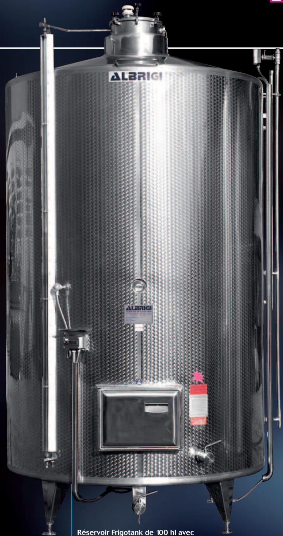
Réservoir Frigotank de 100 hl avec chemise "Termostar" isolation "Isotank", groupe de contrôle de la température avec soupape de commande motorisée "Motorwarve"
