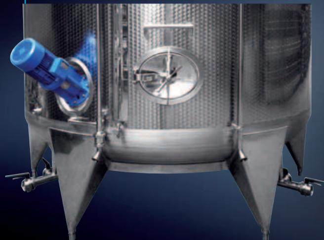
Dispositif d'injection du CO<sub>2</sub> avec clapet de retenue en acier inoxydable d'exclusion
