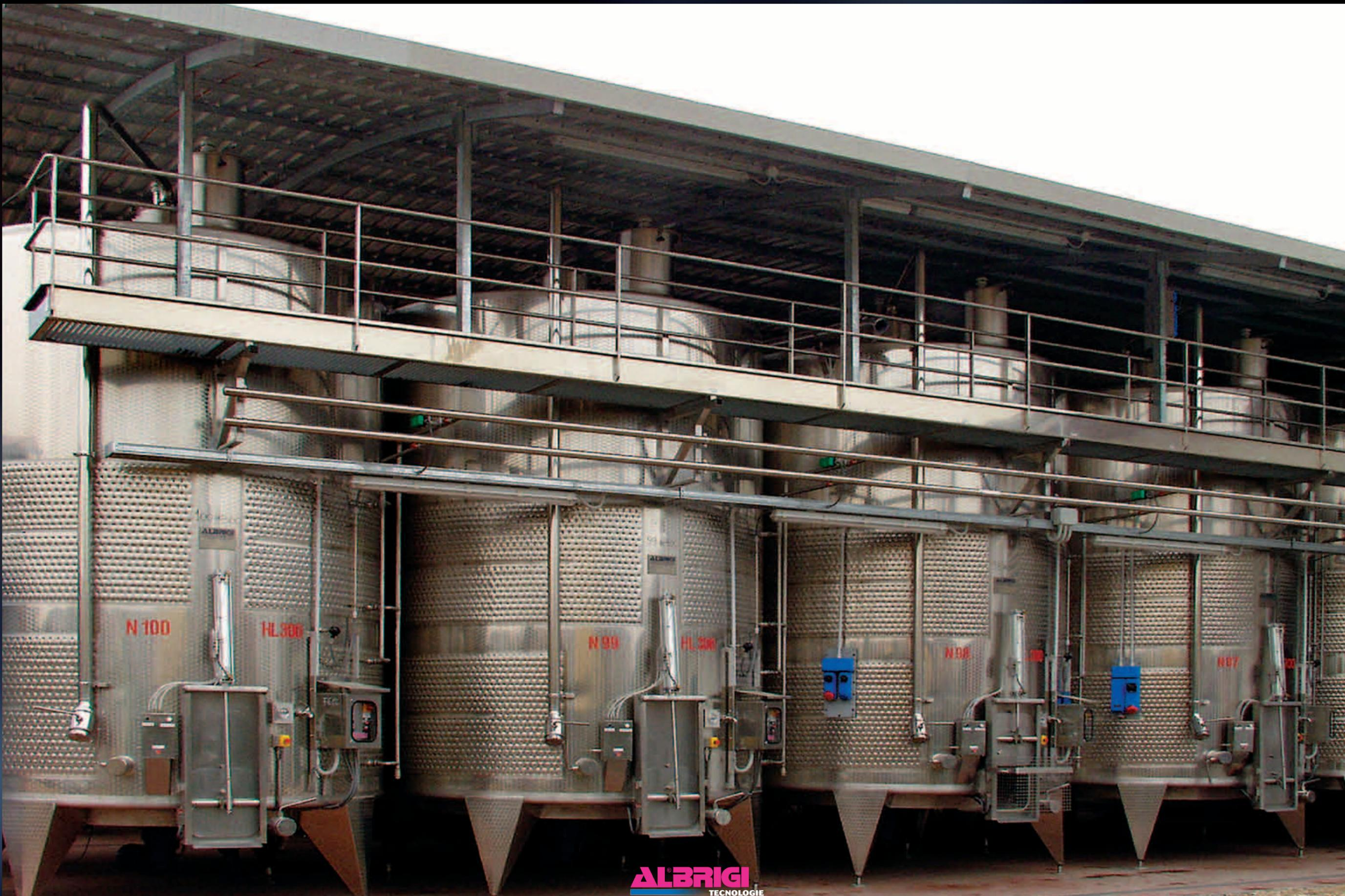
Fermentateurs Meccanotank de 300 hl thermoconditionnés avec Termostar Double avec Palitank de délestage
