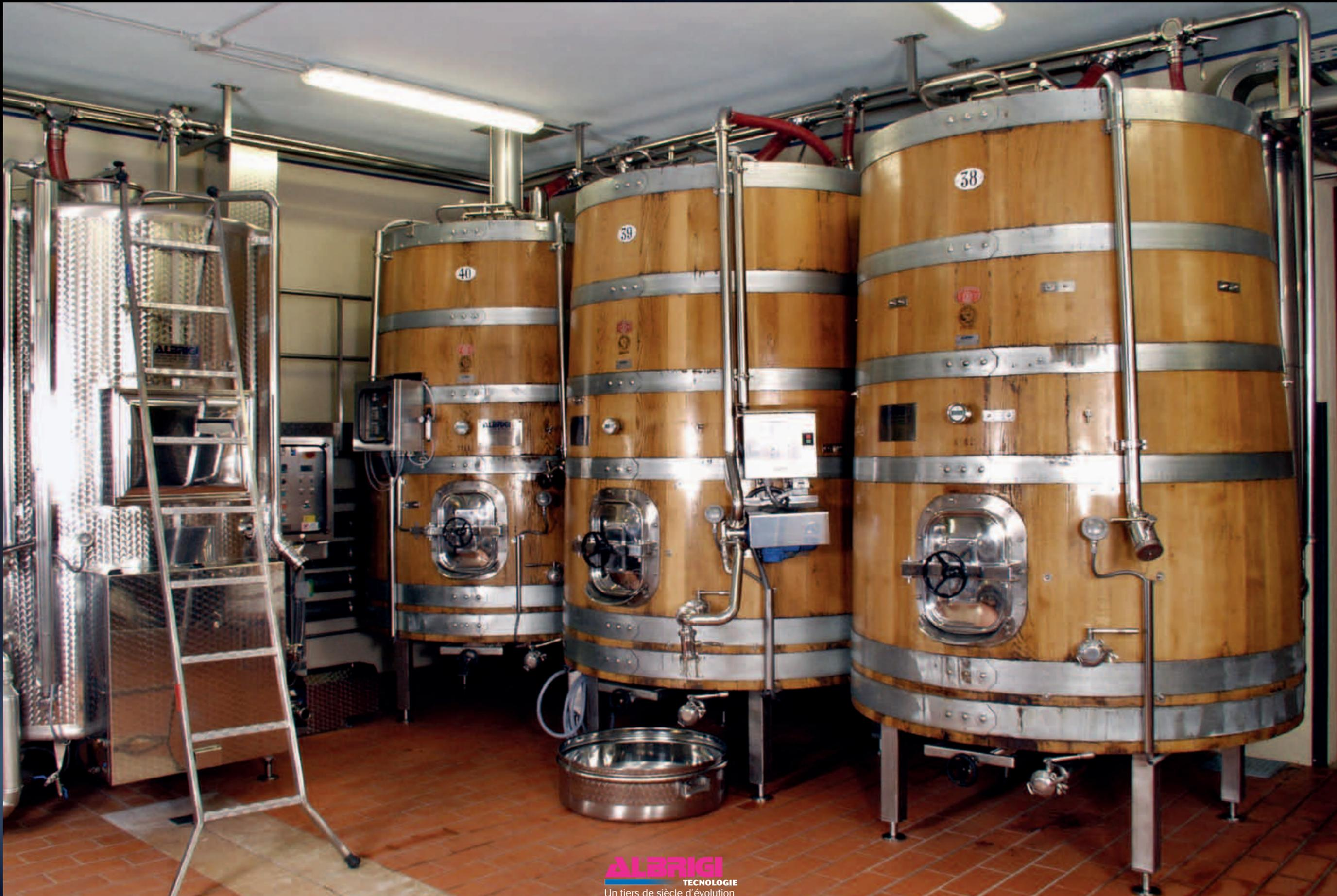
Criotank en acier inoxydable et Monofolltank – Palitank / délestage – Supertank en chêne
