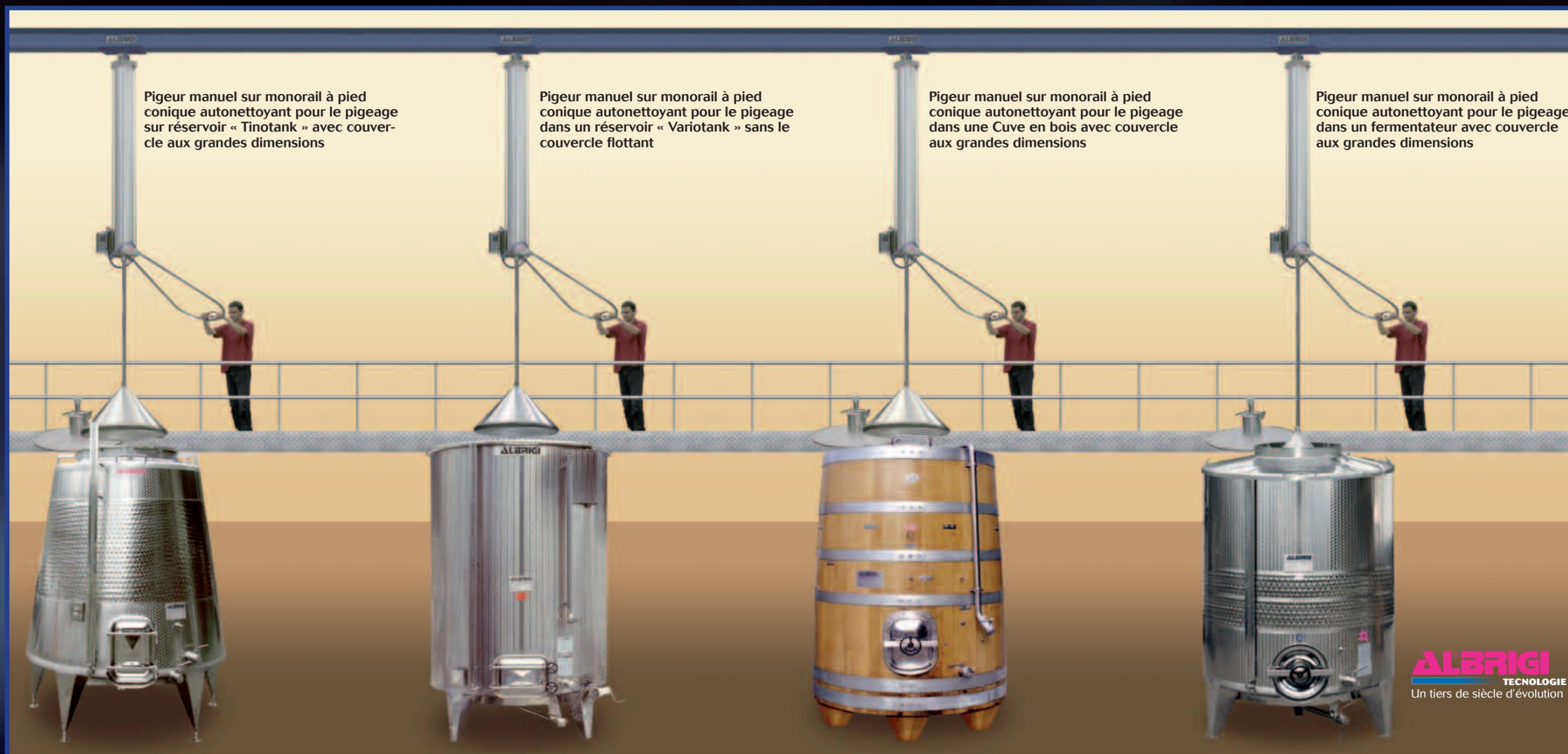
Pigeur manuel sur monorail à pied conique autonettoyant pour le pigeage sur réservoir « Tinotank » avec couvercle aux grandes dimensions
