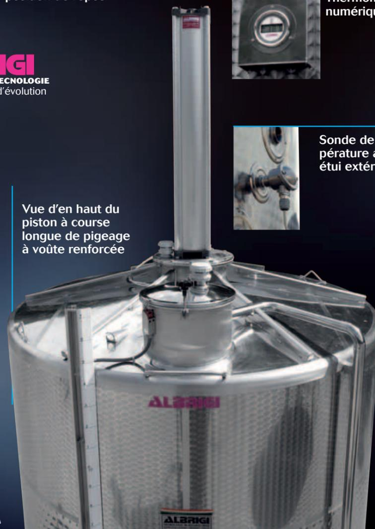
Mécanisme Monofoltank à course longue adaptable à des réservoirs neufs ou existants même en béton
