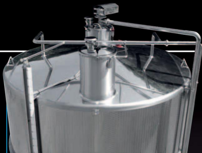
Voûte d'un fermentateur avec double couvercle, arroseur « Motofly » motorisé et installation de lavage « Cleanfix »
