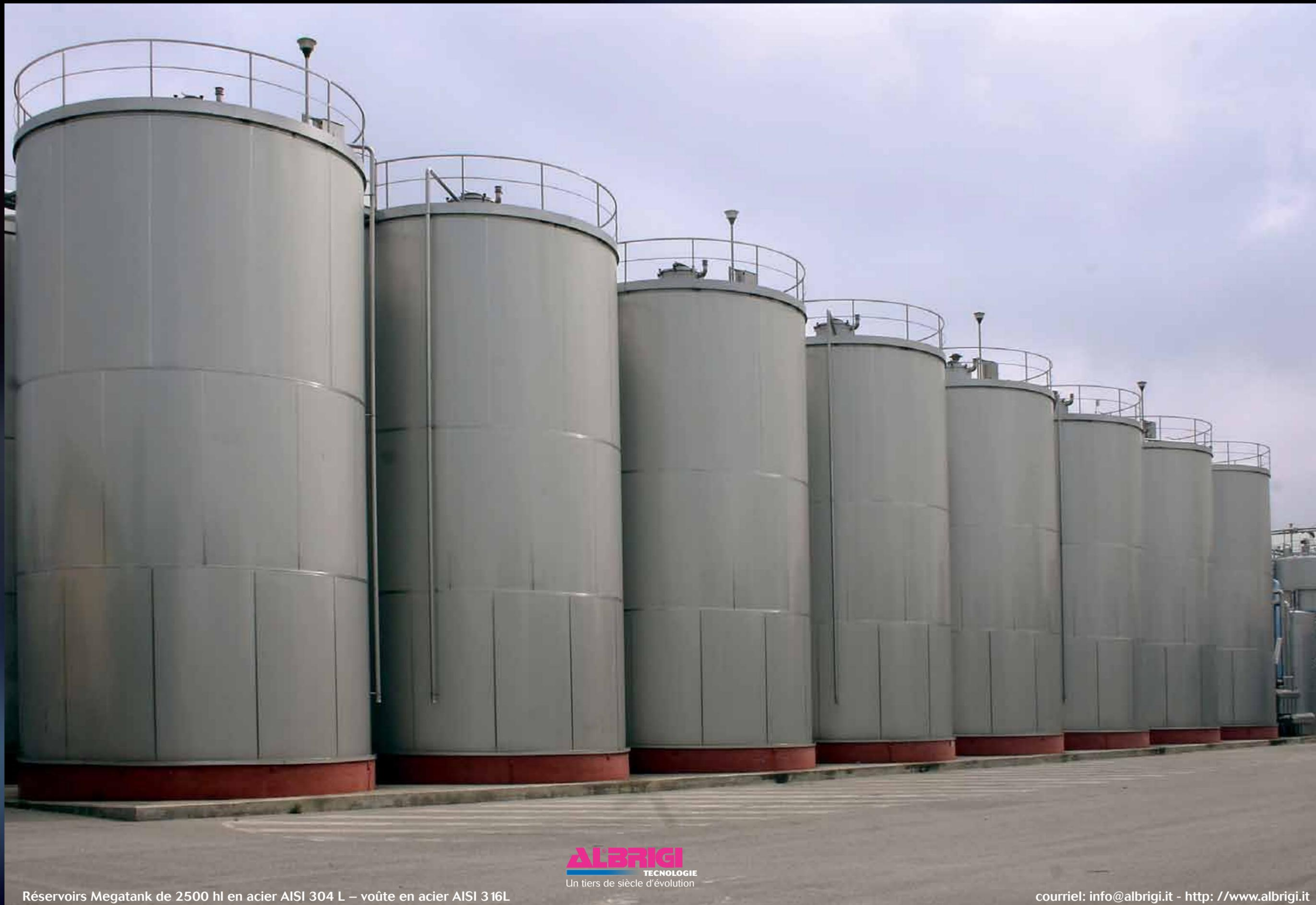
Réservoirs Megatank de 2500 hl en acier AISI 304 L – voûte en acier AISI 316L
