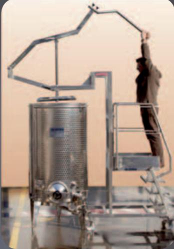
Le pigeage est facile grâce au mécanisme manuel breveté Albrigi
