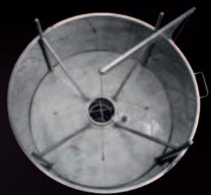
Vue d'une grille montée sur un réservoir semprepieno (toujours plein) Variotank
