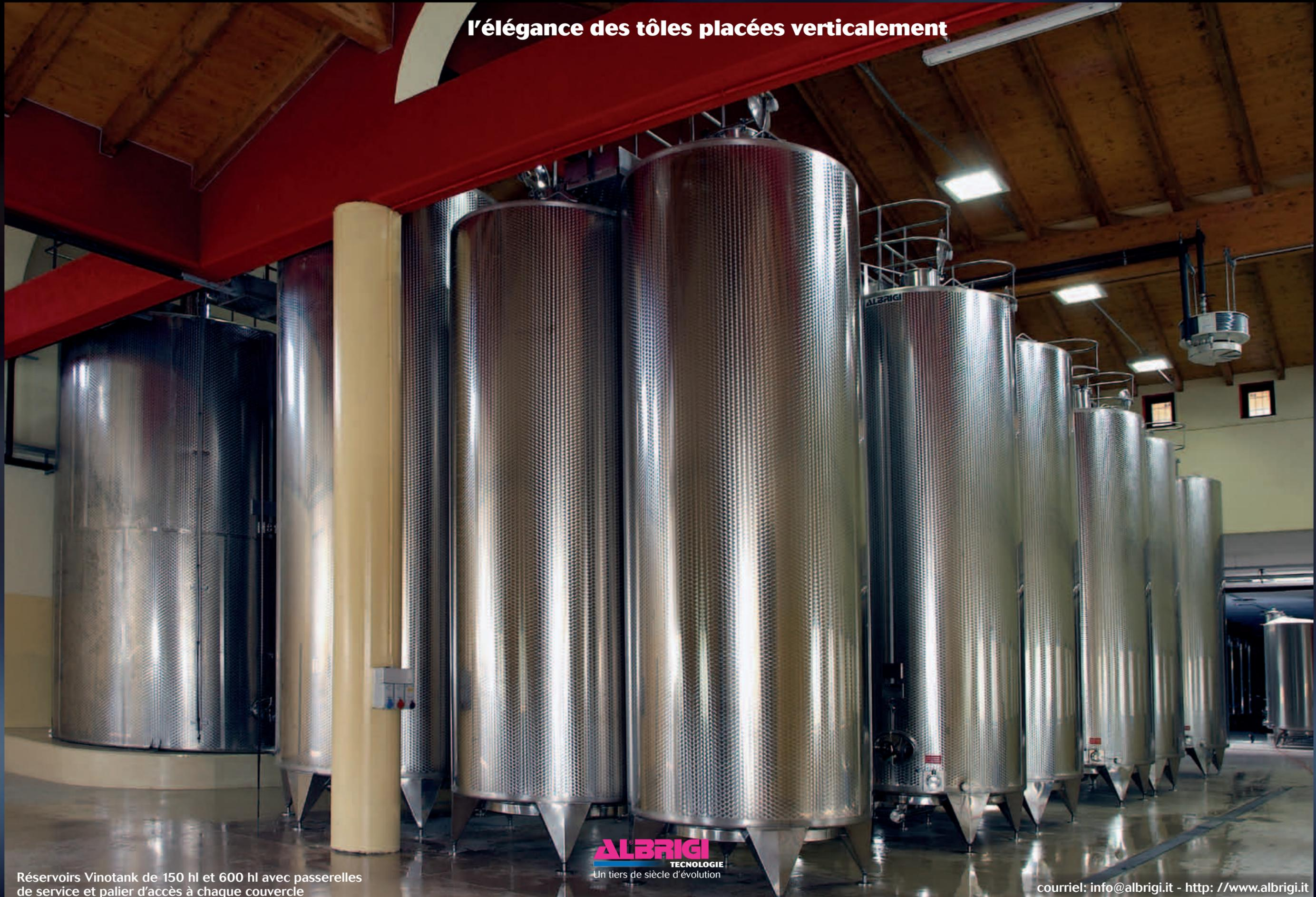
Réservoirs Vinotank de 150 hl et 600 hl avec passerelles de service et palier d'accès à chaque couvercle
