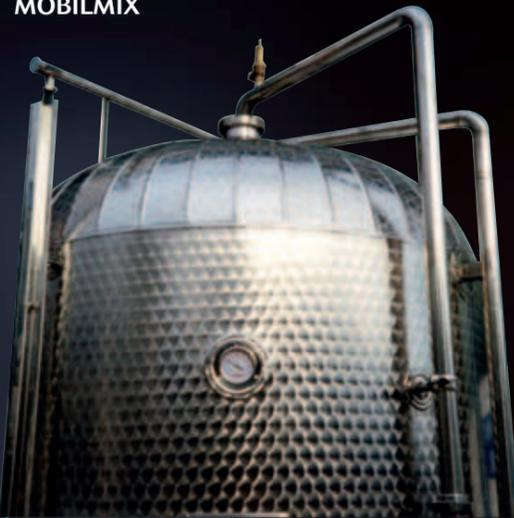
Vue supérieure d'un autoclave avec accessoires de lavage, tuyau du groupe de sécurité et niveau isolé avec Isotherm
