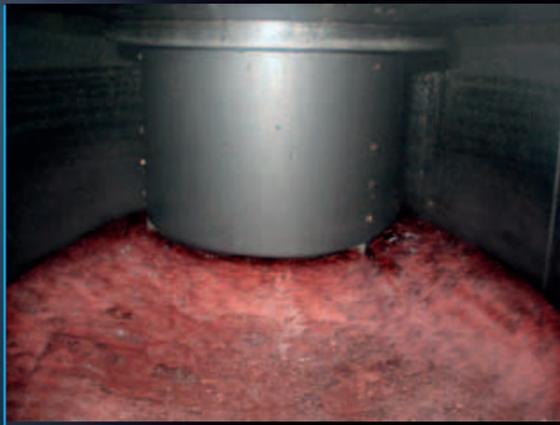
Soupape de chute ouverte avec le flux de moût par chute
