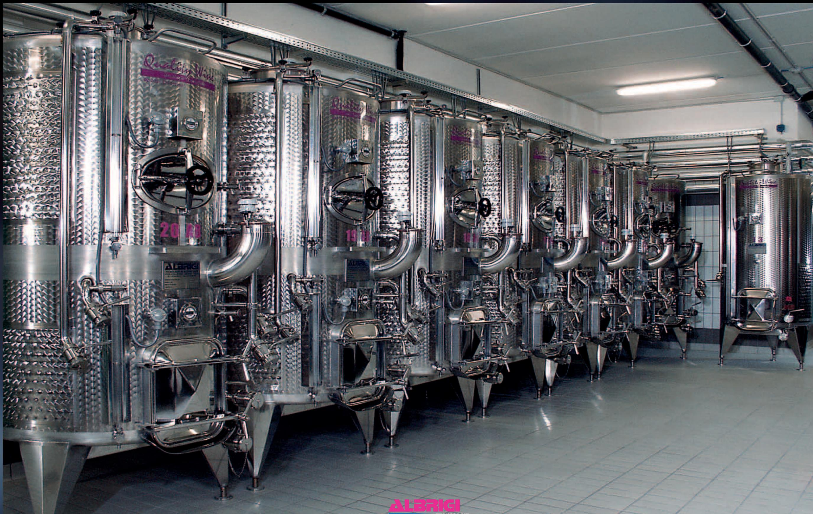
Politank Termo de 10 hl + 15 hl avec compartiment inférieur de fermentation et supérieur de stockage, entièrement thermoconditionnés avec Termostar et équipés d'une installation de lavage Cleanfix
