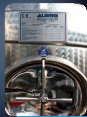
Plaquette de certification de l'essai PED en acier inoxydable
