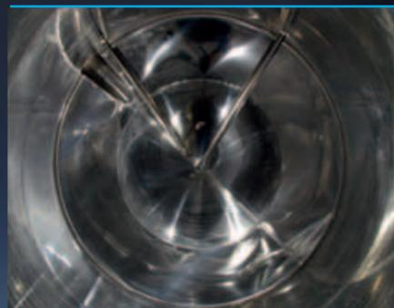
Vue d'en bas du fond breveté Albrigi Superbottom avec canaux purgeurs d'air du couvercle
