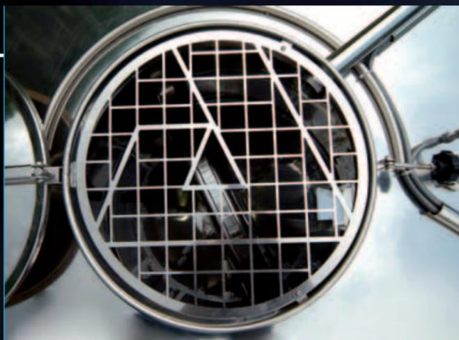
Couvercle supérieur avec cage protectrice et microinterrupteur de sécurité
