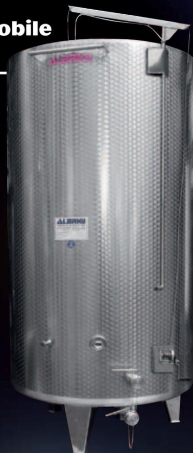
Réservoir Variotank isolé avec Isotank et thermoconditionné avec Termostar pour la stabilisation des vins
