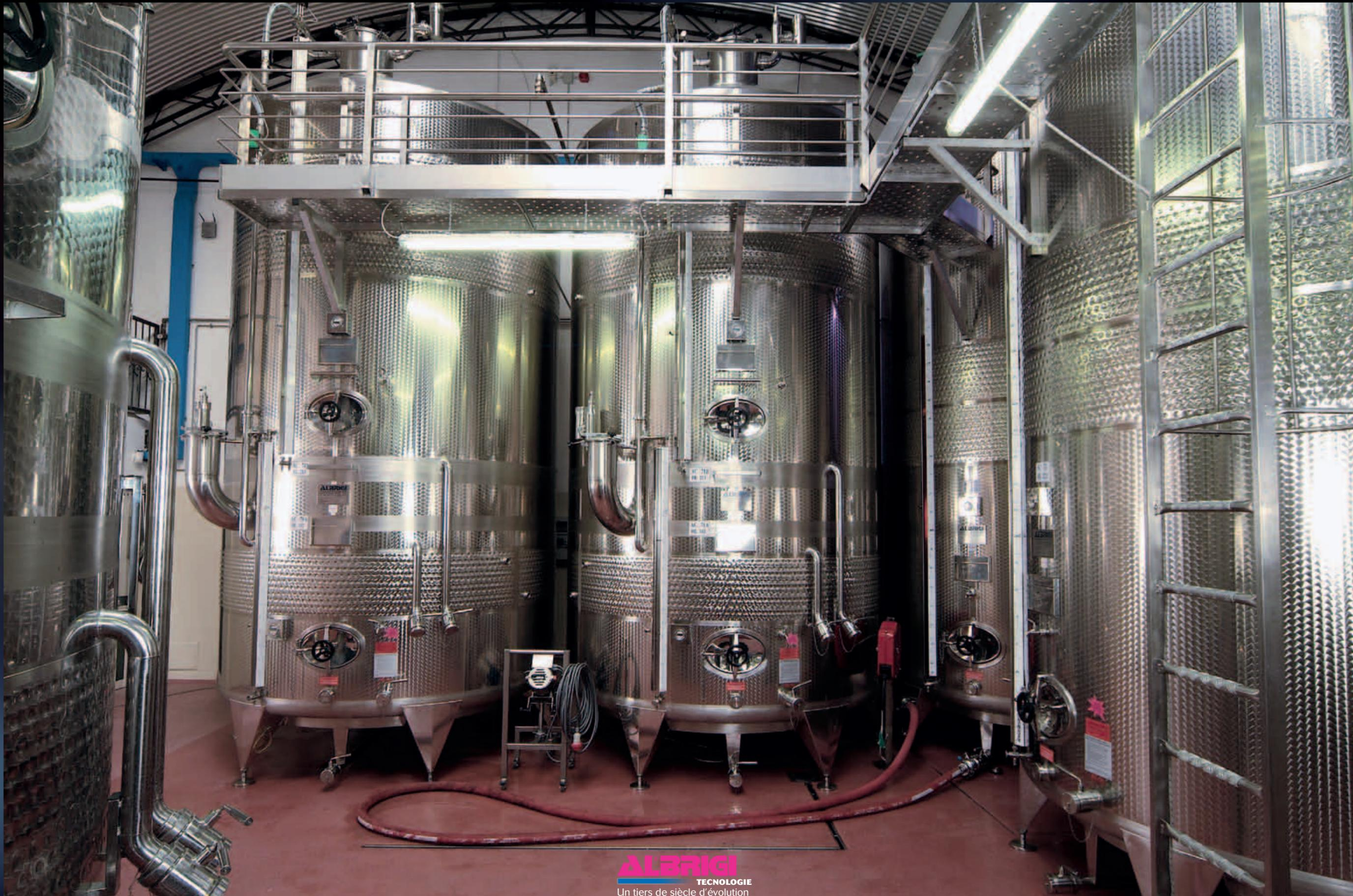
Réservoirs Politank de 100 hl + 200 hl, thermoconditionnés avec chemise Termostar, installation de lavage Cleanfix et Innergas
