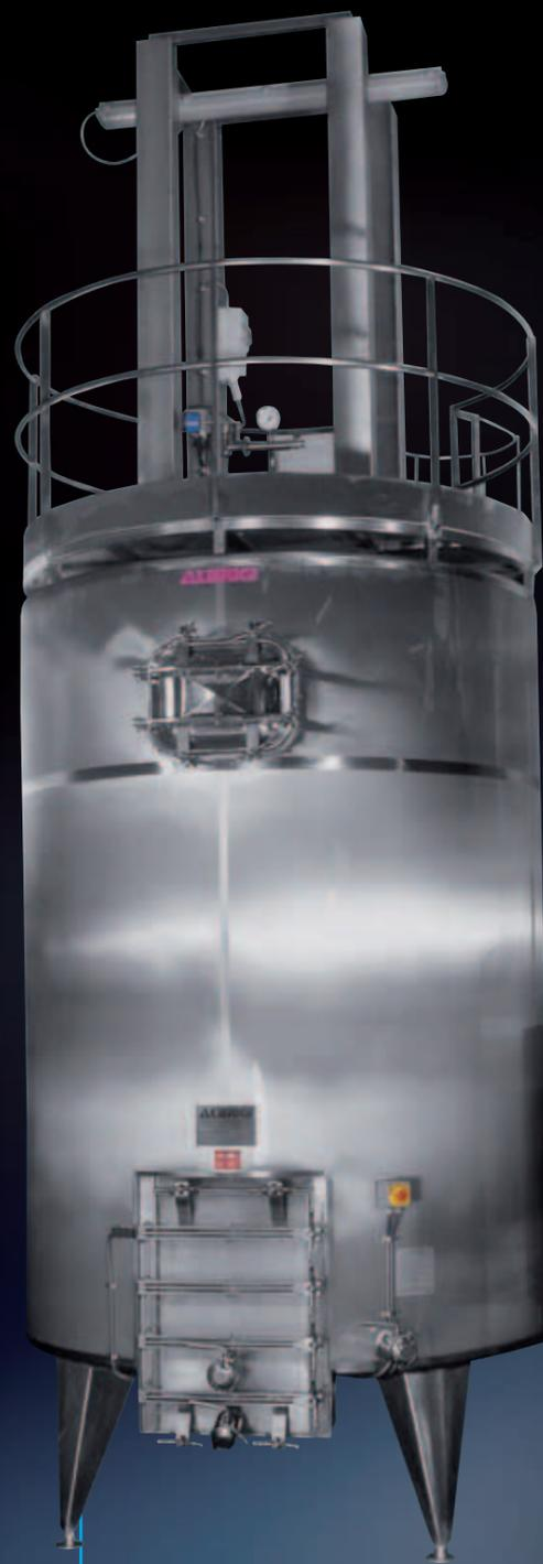
Pigeur hydraulique à 4 pieds spéciaux autonettoyants avec PLC de gestion des phases de pigeage alternées
