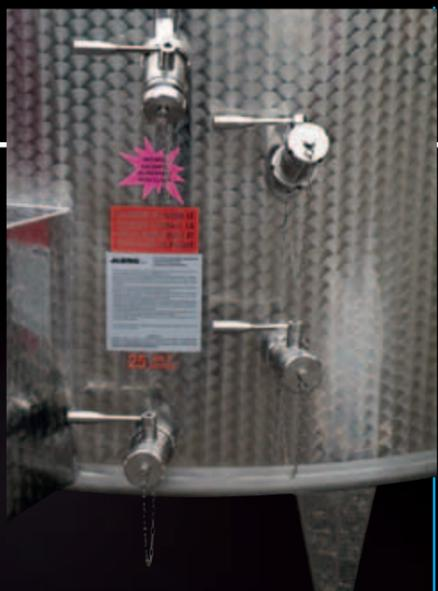
Groupe de soupapes d'un réservoir Frigotank avec vidange totale, partielle, remontage et soupape inclinée pour agitateur amovible MOBILMIX
