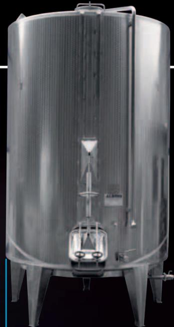
Cryomacérateur nu avec grille de drainage démontable autovidante, inclinée de 30° de 100 hl
