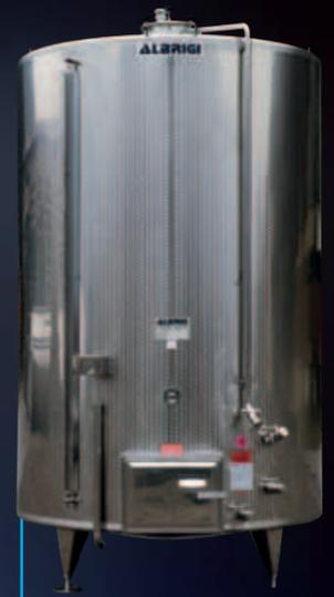
Réservoir Frigotank entièrement conditionné avec « Termostar » même sur le fond et entièrement isolé avec « Isotank »
