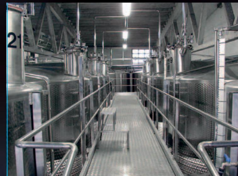
Passerelle avec réservoirs de 300 hl avec groupe de sécurité et installation fixe de tuyaux en acier inoxydable « Innerpipe »
