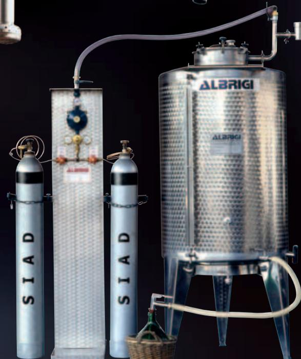
Schéma d'une installation de débit du vin en vrac avec centrale d'inertage par azote Innergas
