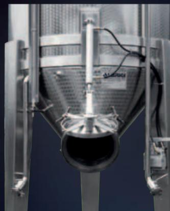
Réservoir Gravitank avec porte entièrement ouverte
