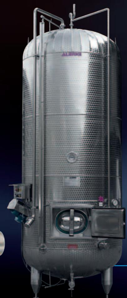
Autoclave Pressuretank thermoconditionné avec Termotig et isolé avec Isotherm, équipé d'un agitateur Sidemix, d'un groupe de sécurité avec soupape étalonnée PED et d'un système de lavage fixe Cleanfix
