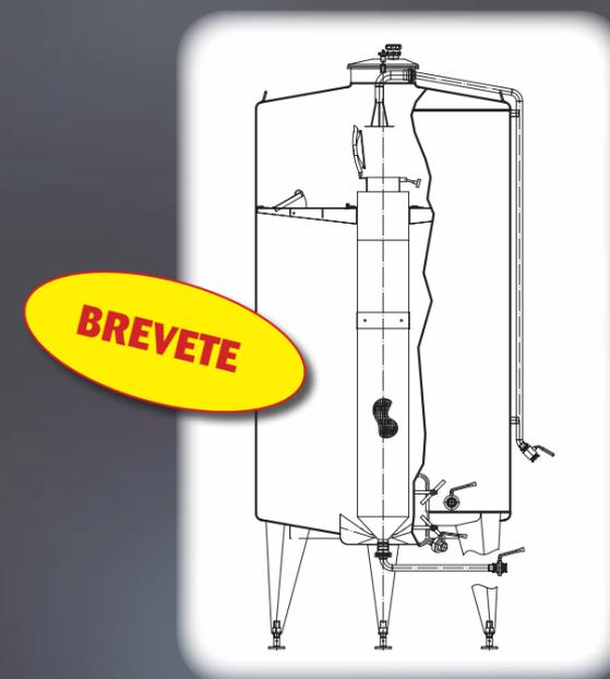
Schéma général de positionnement du mécanisme démontable du chapeau submergé qui peut être adapté à n'importe quel fermentateur existant
