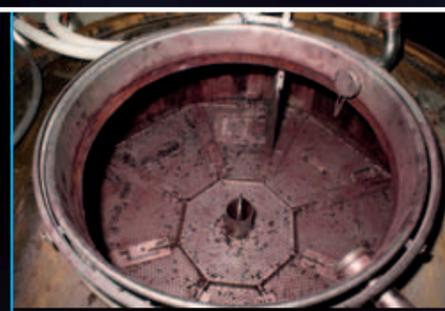
Mécanisme du chapeau submergé sur une cuve en bois, pouvant être démonté de l'extérieur
