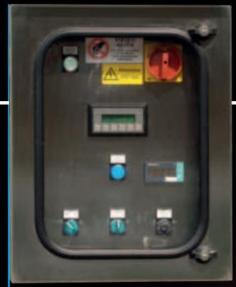
Tableau de contrôle automatique de la température et de gestion de l'agitateur
