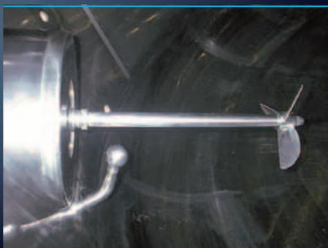
Bille de lavage « Sprayball » pour nettoyer l'agitateur et le joint d'étanchéité mécanique
