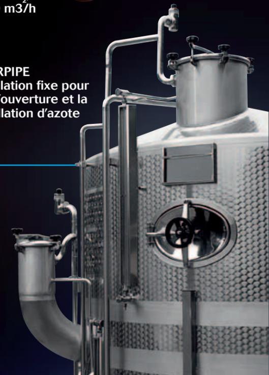
Centrale de stockage fixe, avec Innergas pour servir plusieurs réservoirs, fonctionnant par azote ou CO<sub>2</sub>, de 20 à 100 m<sup>3</sup>/h
