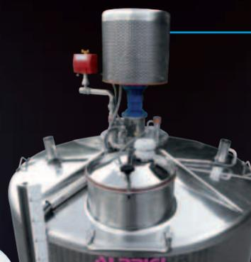
Turbotank thermo-conditionné avec soupape motorisée « Motorvalve » de recirculation du glycol dans la chemise
