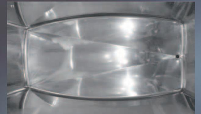
Vue d'en haut de l'intérieur du réservoir Compatank aux bords et arêtes arrondis, faciles à nettoyer et au fond façonné autovidant
