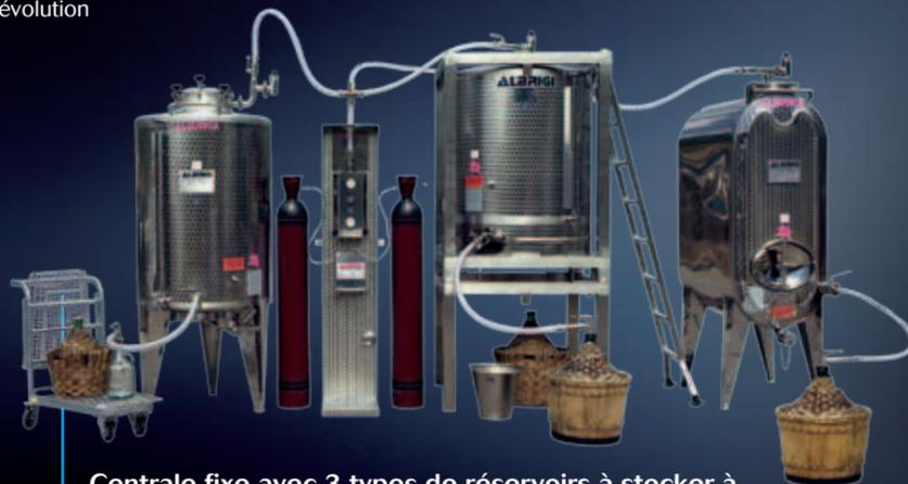
Centrale fixe avec 3 types de réservoirs à stocker à 20 mb de pression avec azote pour la vente du vin en vrac
