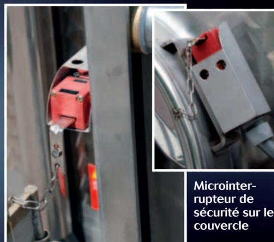
Microinterrupteur de sécurité sur la porte
