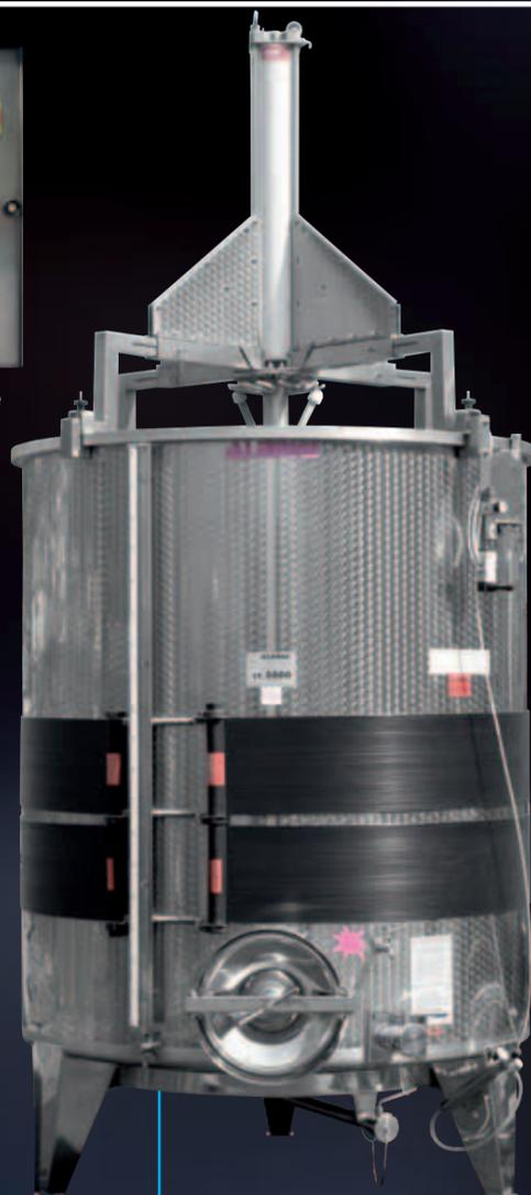
Vue extérieure et de l'intérieur d'un mécanisme de pigeage "Variofolltank" sur un réservoir semprepieno (toujours plein) de 50 hl
