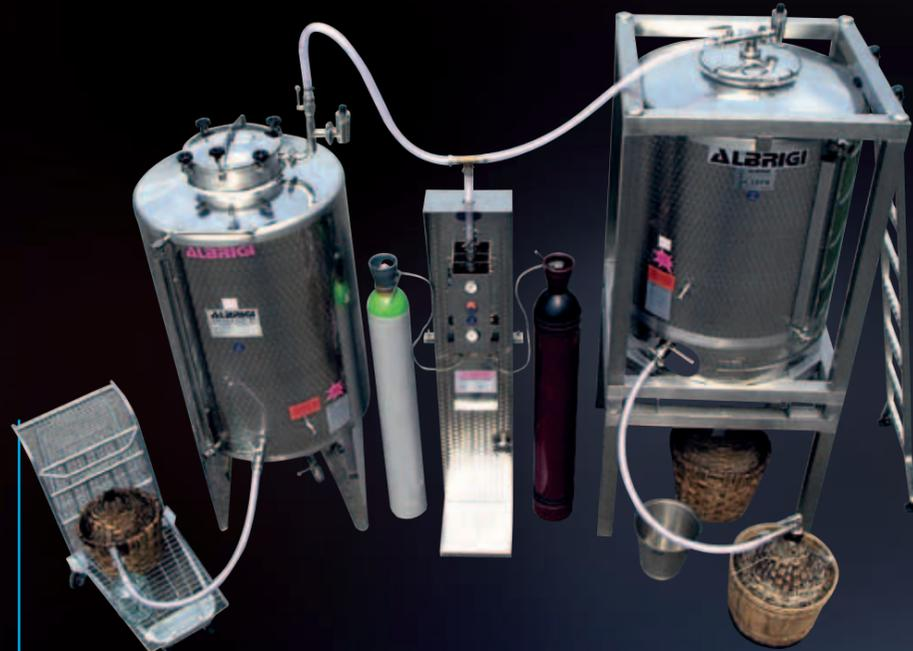
Réservoir Enoalet de 1000 l isolé avec centrale pour azote et Minitanke série « S » de 1000 l
