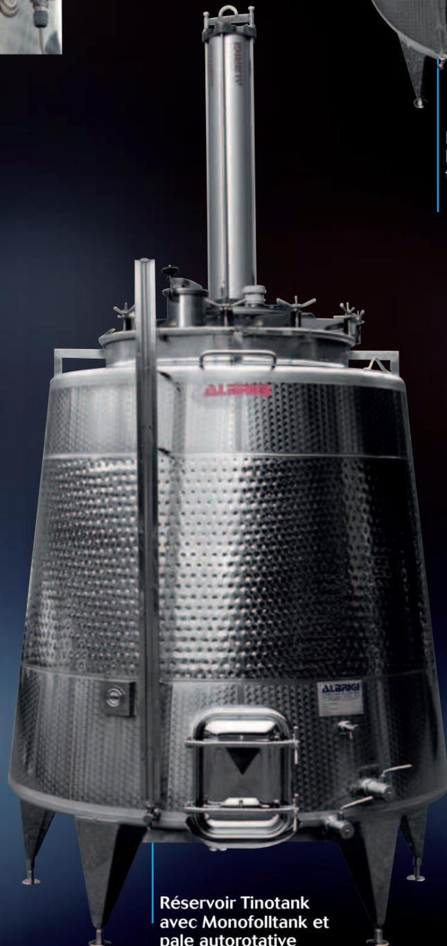
Réservoir Tinotank avec Monofolltank et pale autorotative
