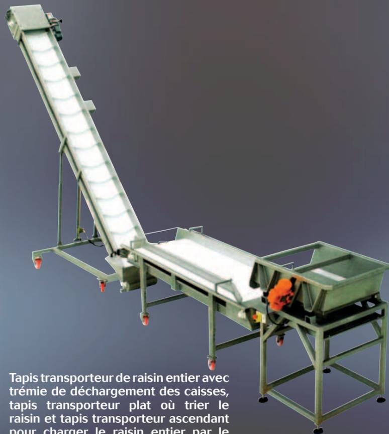
Tapis transporteur de raisin entier avec trémie de déchargement des caisses, tapis transporteur plat où trier le raisin et tapis transporteur ascendant pour charger le raisin entier par le haut, moyennant entonnoir dans le fermentateur Noveltank
