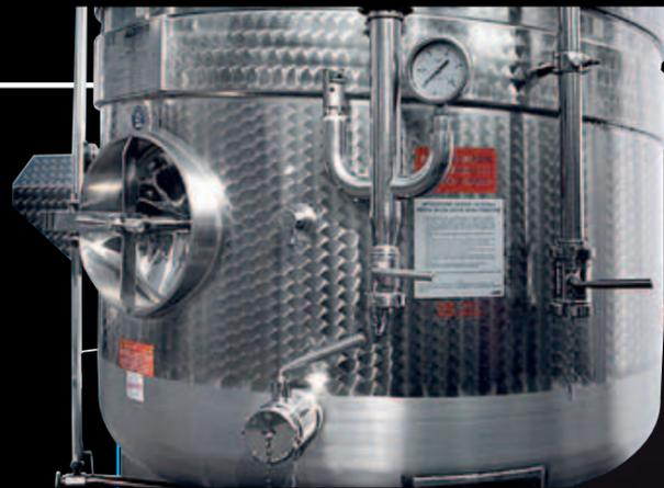
Groupe de sécurité avec soupape étalonnée PED
