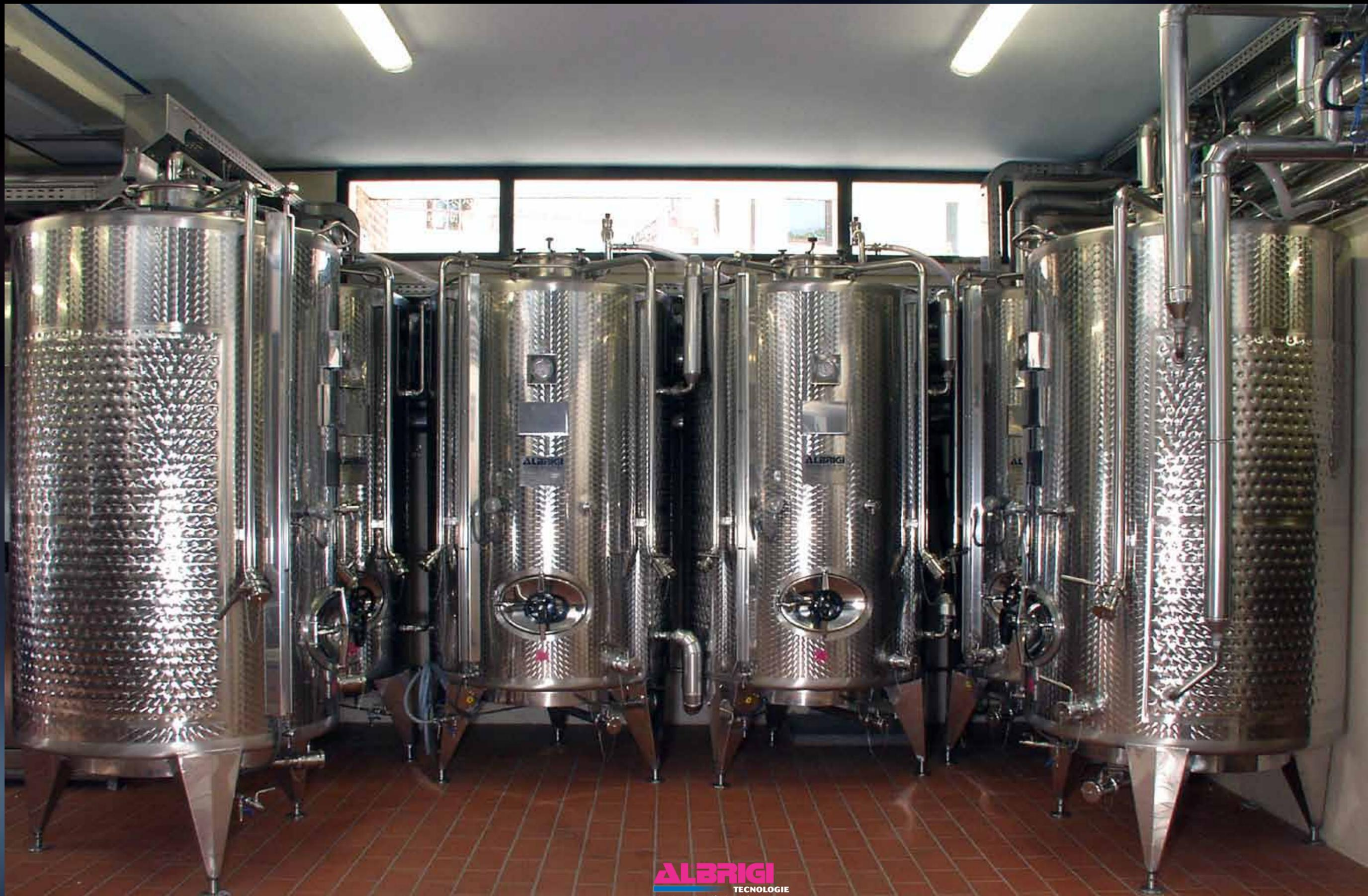
Atelier de stockage équipé de réservoirs avec chemises Termostar pour la fermentation malolactique avec Innergas
