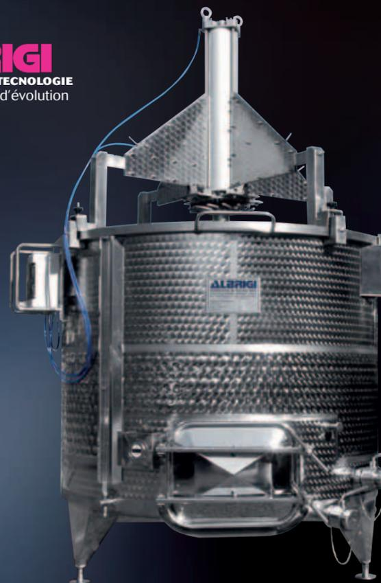
Réservoir de fermentation Variotank Termo avec mécanisme de piégeage mobile et réglable pour différents diamètres
