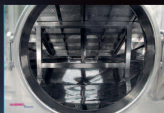
Vue intérieure de la partie inférieure de la grille d'égouttage à travers la porte inférieure
