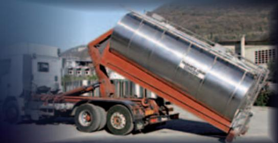
Transtank, réservoir de 16.000 l fixe sur train routier
