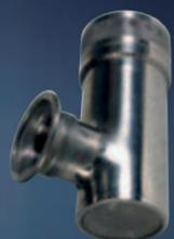
Soupape en acier inoxydable à 2 effets Ø 40 - 50 - 60 - 80 mm démontable avec 2 plateaux de poids pour la surpression et la dépression avec joints d'étanchéité toriques en viton et téflon anti-collant
