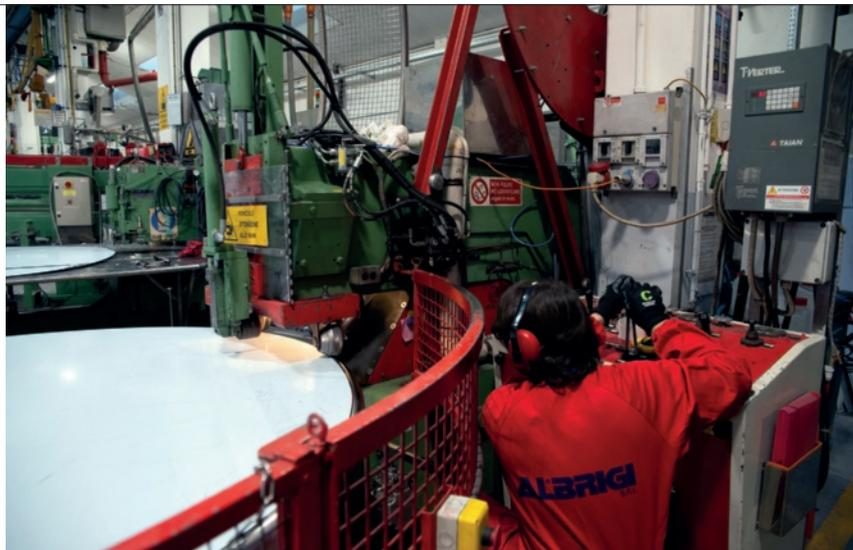
L'addetto prepara il fondo di un serbatoio con una macchina messa a punto espressamente per Albrigi.
