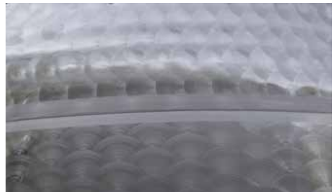
Satin finish Tig welding of the double wall border Saldatura del bordo dell'intercapedine a Tig satinata
