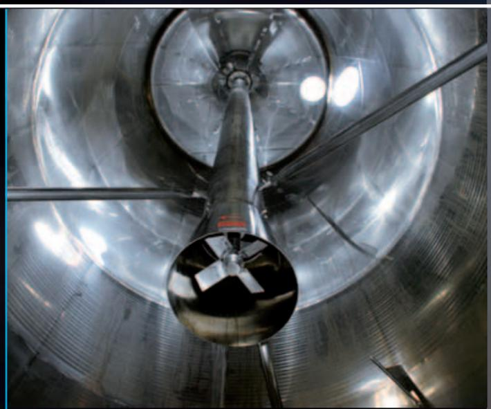
Turbotank applicato all'interno di un fermentatore da hl 1000
