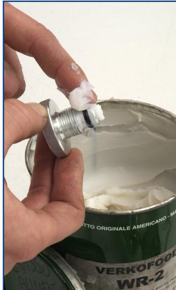
**RICONDIZIONAMENTO BATTUTA VALVOLA** Il teflon che fa da battuta in testa al pomello va tenuto sempre pulito e perfettamente piano e se nel tempo si deforma e spande va spianato bene in testa SPIANANDOLO 1 mm max circa con carta abrasiva grana fine e così va ripristinato il contatto e la tenuta.
