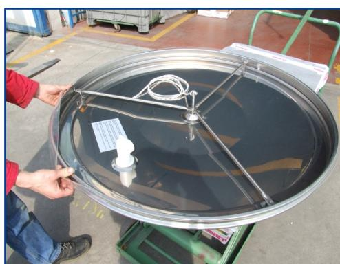
I. Una volta stesa la camera d'aria su tutta la superficie sistemerla accuratamente nella propria sede.
