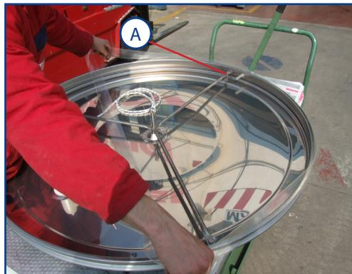
I. Stendere la camera d'aria ed infilare il tubicino di raccordo nel foro del galleggiante (A).
