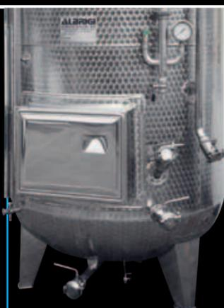
Frigotank con serie di valvole di scarico totale e parziale, e per agitatore estraibile Mobilmix e iniettore di CO<sub>2</sub> dal basso
