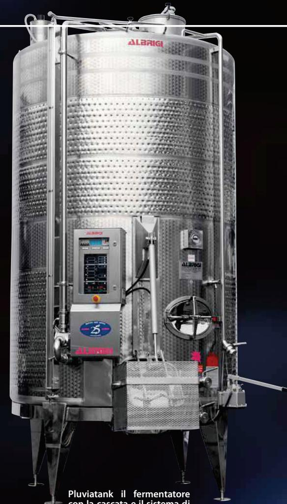
Pluviatank il fermentatore con la cascata e il sistema di ossigenazione del mosto
