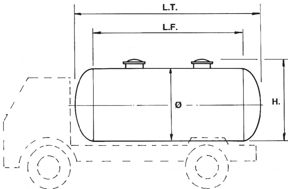
1 Misure standard AISI 304 pronte a magazzino. Nel caso di serbatoio isolato le misure aumentano circa di 18 cm in larghezza e 30 cm in lunghezza.
