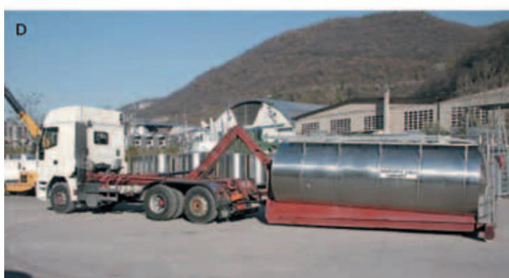
**I** Sequenza del posizionamento di un serbatoio scorrabile termocondizionato e isolato, provvisto di impianto di lavaggio fisso, agitatori e passerella, adibito al trasporto e allo stoccaggio momentaneo di prodotti chimici/alimentari.
